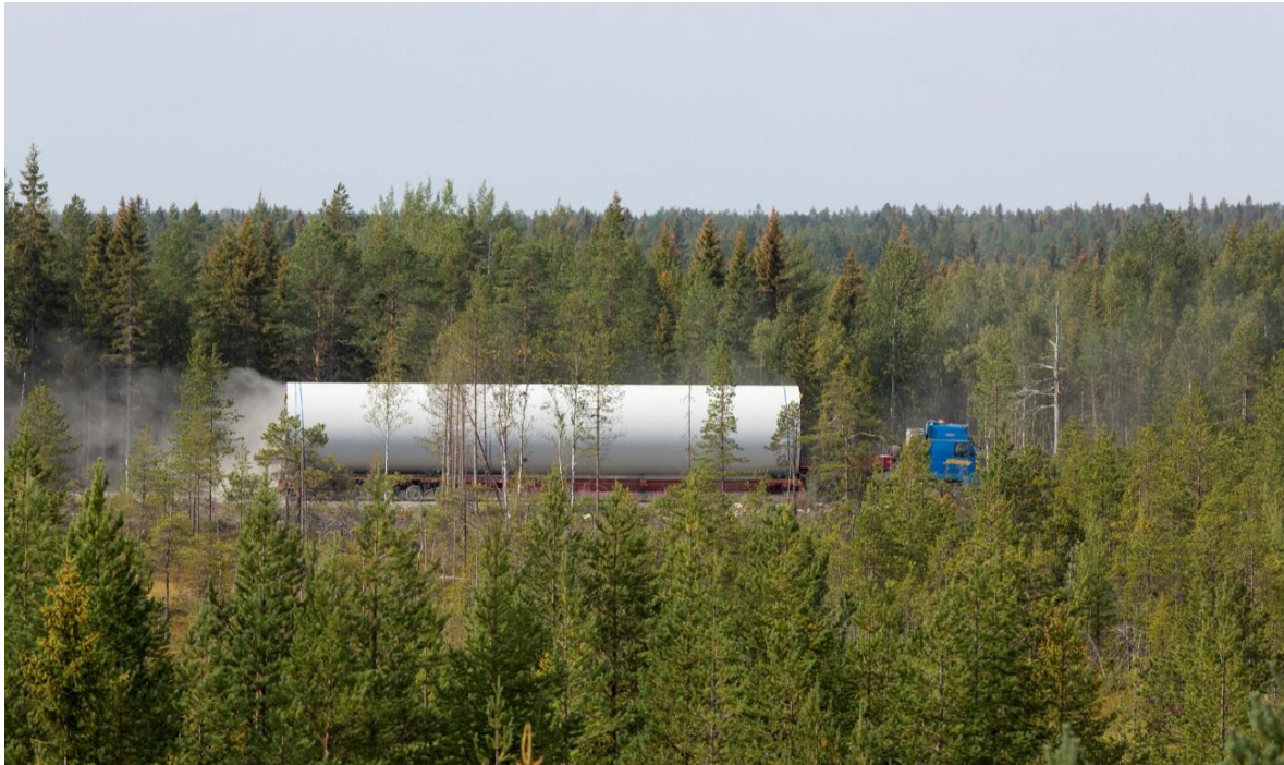
Kuva 130. Tuulivoimalan torniosien kuljetusta (FCG Finnish Consulting Group Oy).
