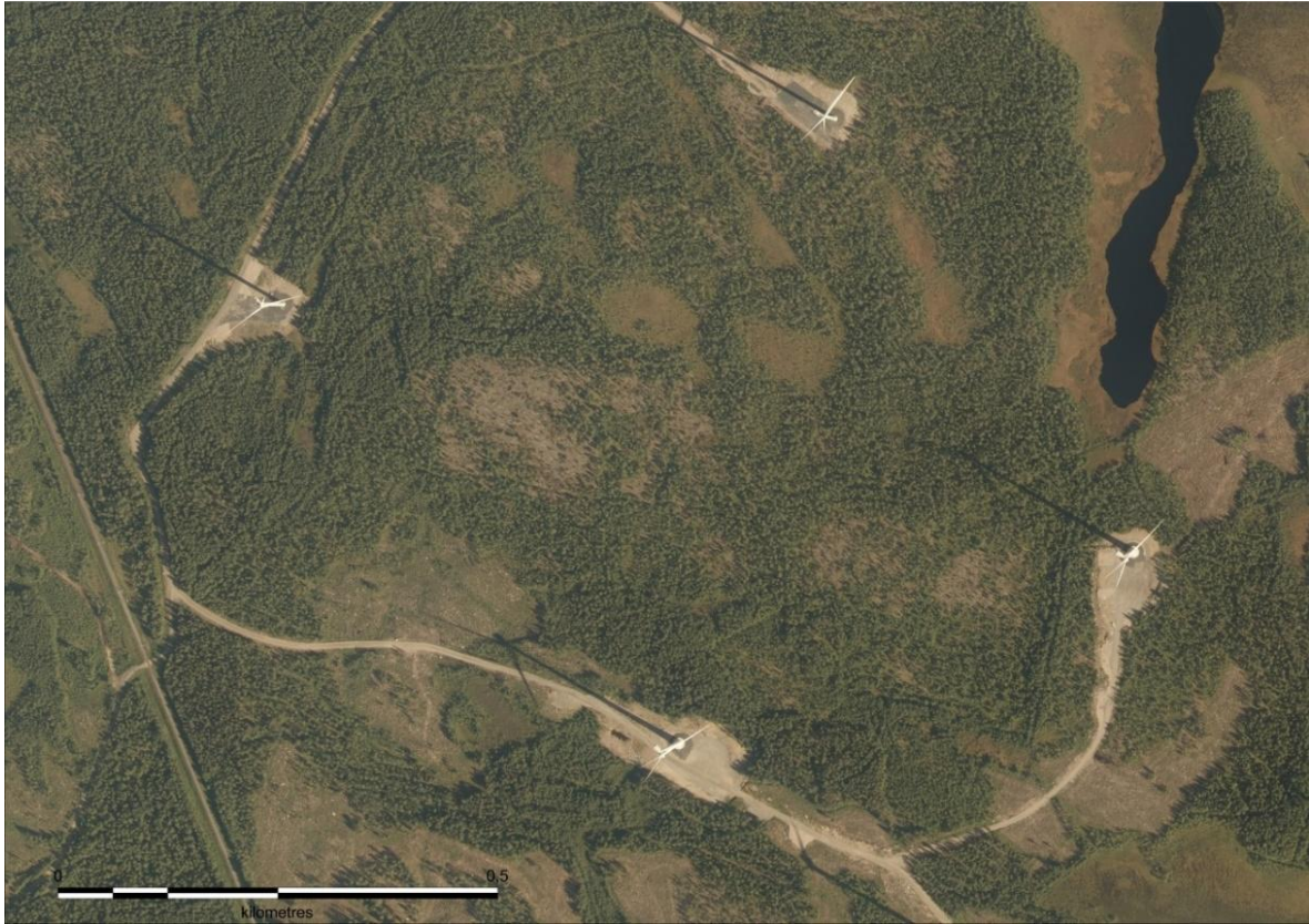
Kuva 123. Esimerkkikuva toiminnassa olevasta tuulivoimapuistosta. Tuulivoimaloita varten on rakennettu huoltotiet ja nostokentät. Tuulivoimaloiden ympäristössä ja välialueilla aikaisempi maankäyttö on säilynyt ennallaan.
